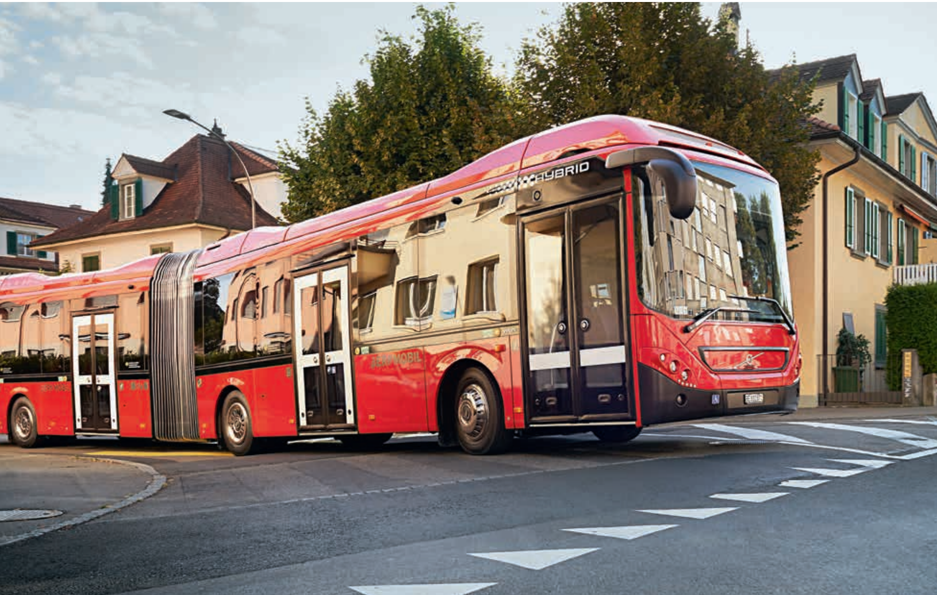
Dank der Kombination von Elektro- und Dieselmotor sparen die neuen Hybridbusse von BERNMOBIL mehr als 20 Prozent Treibstoff ein.
