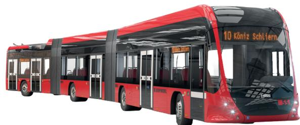
Die Doppelgelenktrolleybusse sind knapp 25 Meter lang und bieten mehr Platz. Visualisierung: Hess AG
